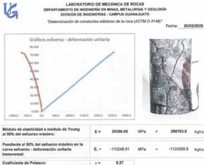
Figura 3.- Muestra de conglomerado analizada para determinar las propiedades geomecánicas de la roca intacta y cargar los valores al software RocLab.
