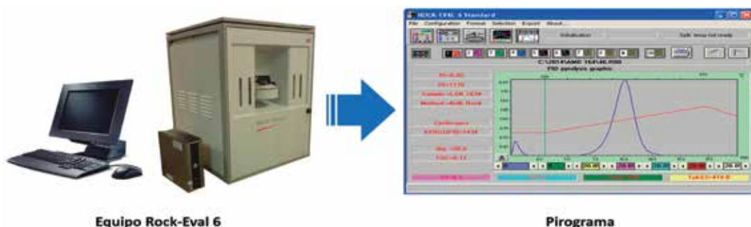
Figura 4 Equipo de pirólisis Rock-Eval® y obtención del pirograma.
