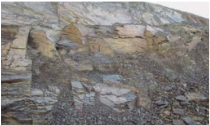
Fotografía 1. Aspecto del macizo rocoso en uno de los bancos de explotación de la capa superficial. Se puede apreciar la naturaleza laminada o “en lascas” del material y los planos estructurales lisos.
