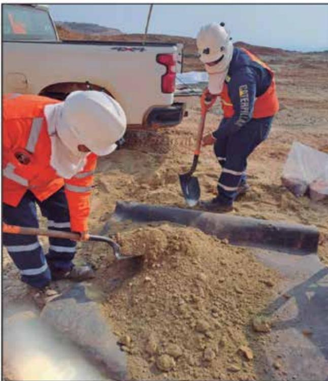
Figura 4. Primera homogenización del ripio
