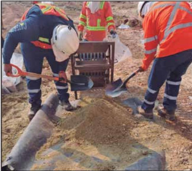
Figura 3. Toma de ripio total del barreno
