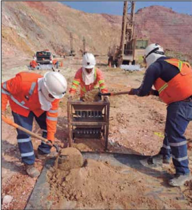
Figura 7. Cuarteo de ripio en cuarteador metálico.
