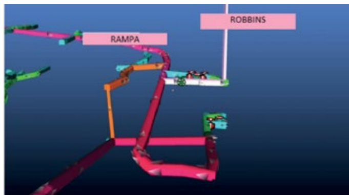
Figura 4. Simulación en software ventsim al implementar la rampa e instalar el ventilador.
