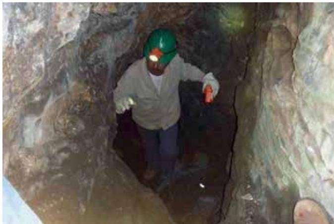
Fotografía 22. Entrada al prospecto de La Torre, cuya mineralización de óxidos de hierro se encuentra asociada al plano de una falla normal de rumbo NW-SE.
