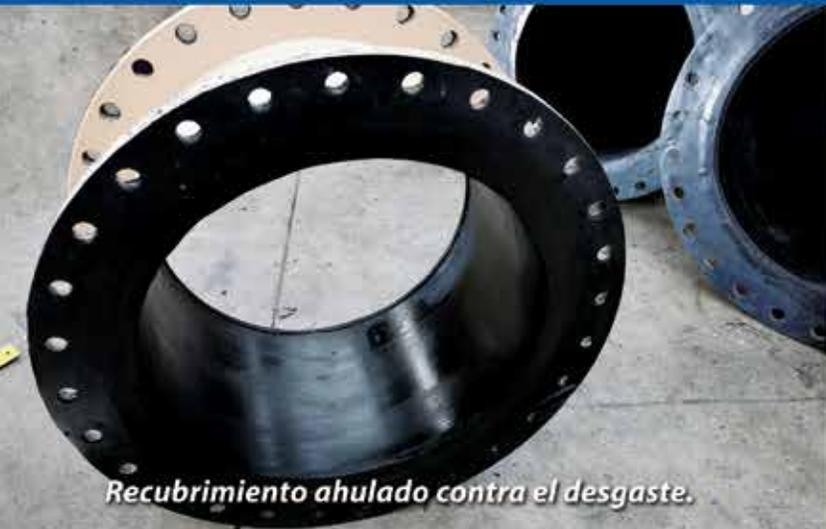
*Recubrimiento ahulado contra el desgaste.*
