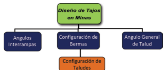
Figura 2. Principales Fases en el Diseño de Tajos (Read y Stacey, 2010).
