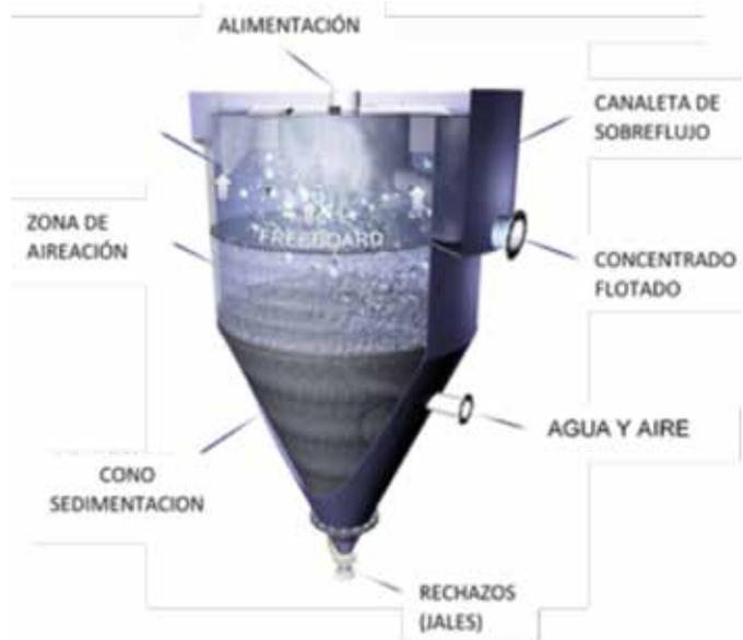
Figura 2. Corte transversal del equipo HydroFloat™ Eriez
