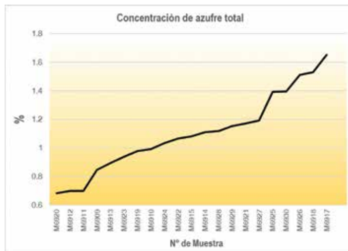
Gráfica 2. Representación gráfica de los resultados de la concentración de azufre total, con un promedio de 1.10%, realizados bajo la Norma ASTM D4239.
