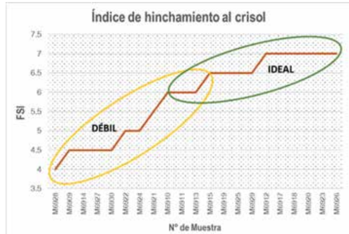
Gráfica 4. Resultados del índice de hinchamiento al crisol (FSI), que muestran una tendencia del 50% de las muestras estudiadas como ideal para la coquización. La caracterización se realizó bajo la norma ASTM D720.
