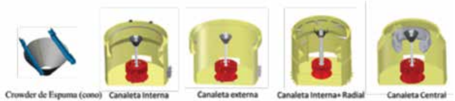
Figura 7. Tipo de canaletas y crowder disponibles para celdas grandes de flotación.
