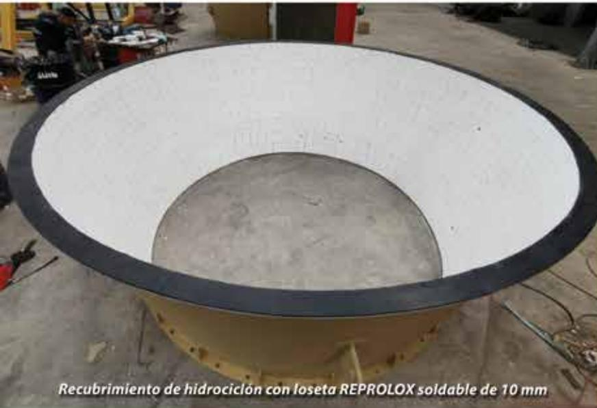
Recubrimiento de hidroción con loseta REPROLOX soldable de 10 mm
