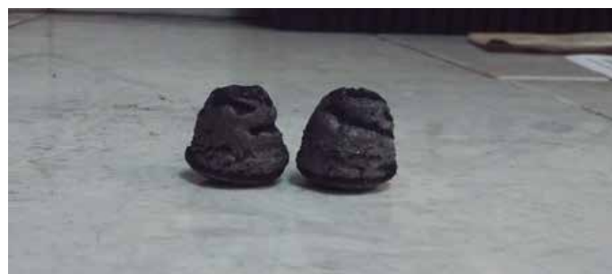
Figura 2. Botón de coque de carbón obtenido del análisis del FSI. Fuente: propia.
