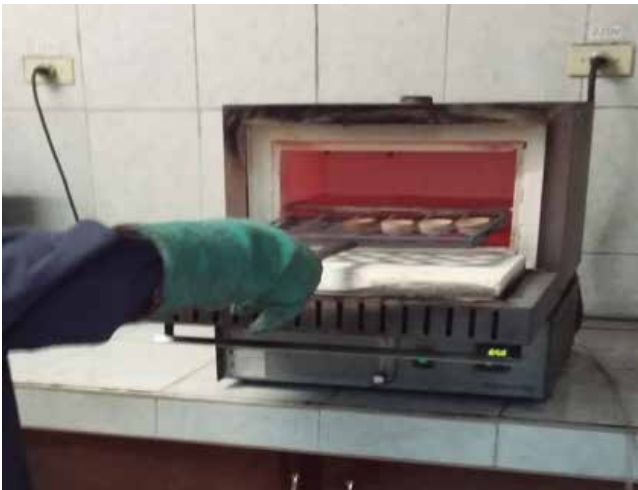
Figura 1. Ingreso de muestras en la mufla (Thermolyne F6020C-33-60-80) a 750 °C, cumpliendo con las normas de seguridad del laboratorio (Guante protector, bata antífama y careta protectora). Fuente: propia.
